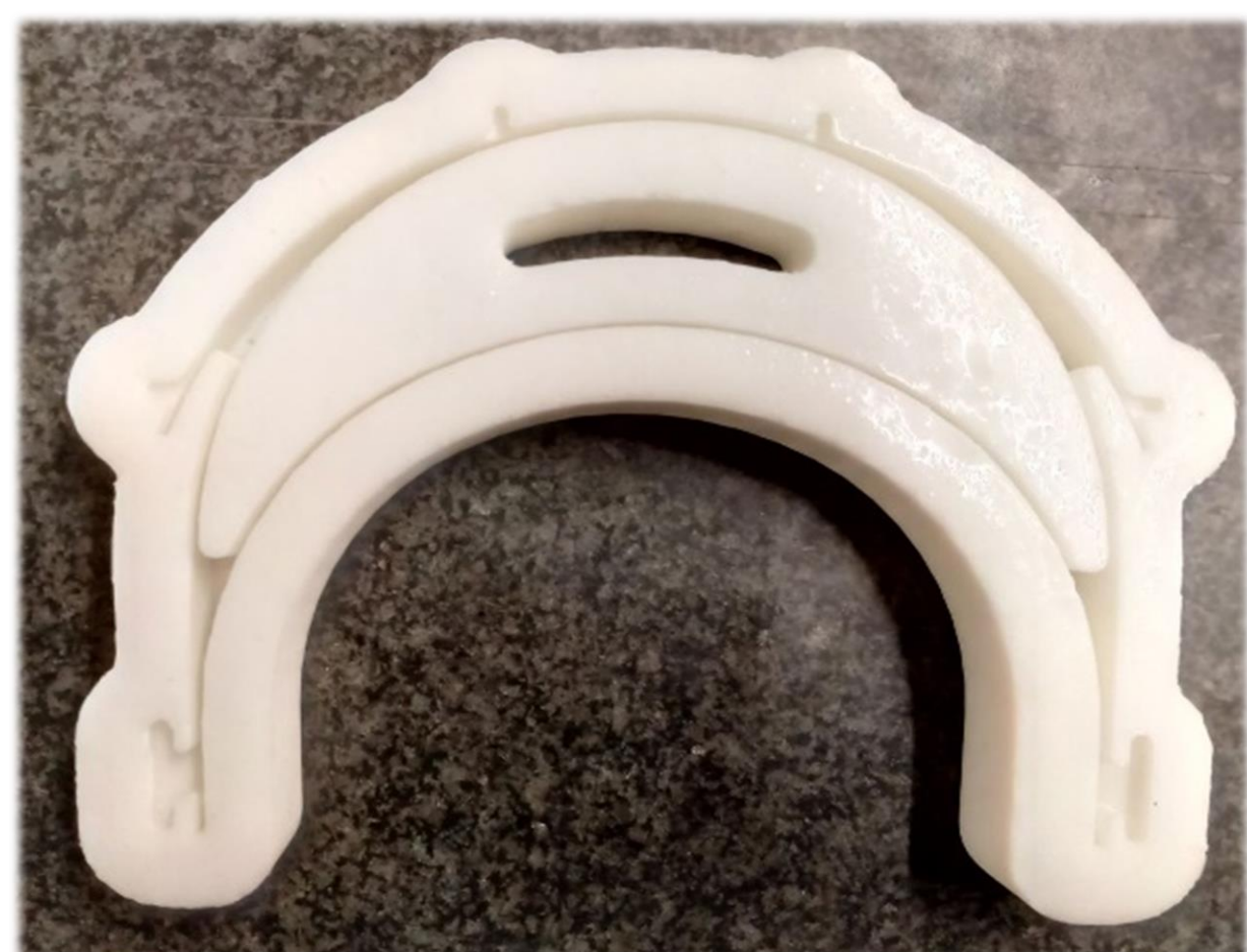
Καλούπι σιλικόνης μετά την πήξη και απομάκρυνση από το καλούπι του.
