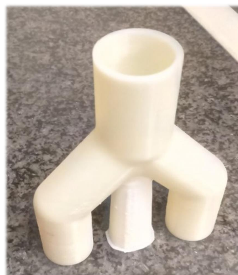
Χρήση τεχνολογιών FDM, SLA για την τρισδιάστατη εκτύπωση πρωτοτύπων splitters για ιατρικούς αναπνευστήρες
