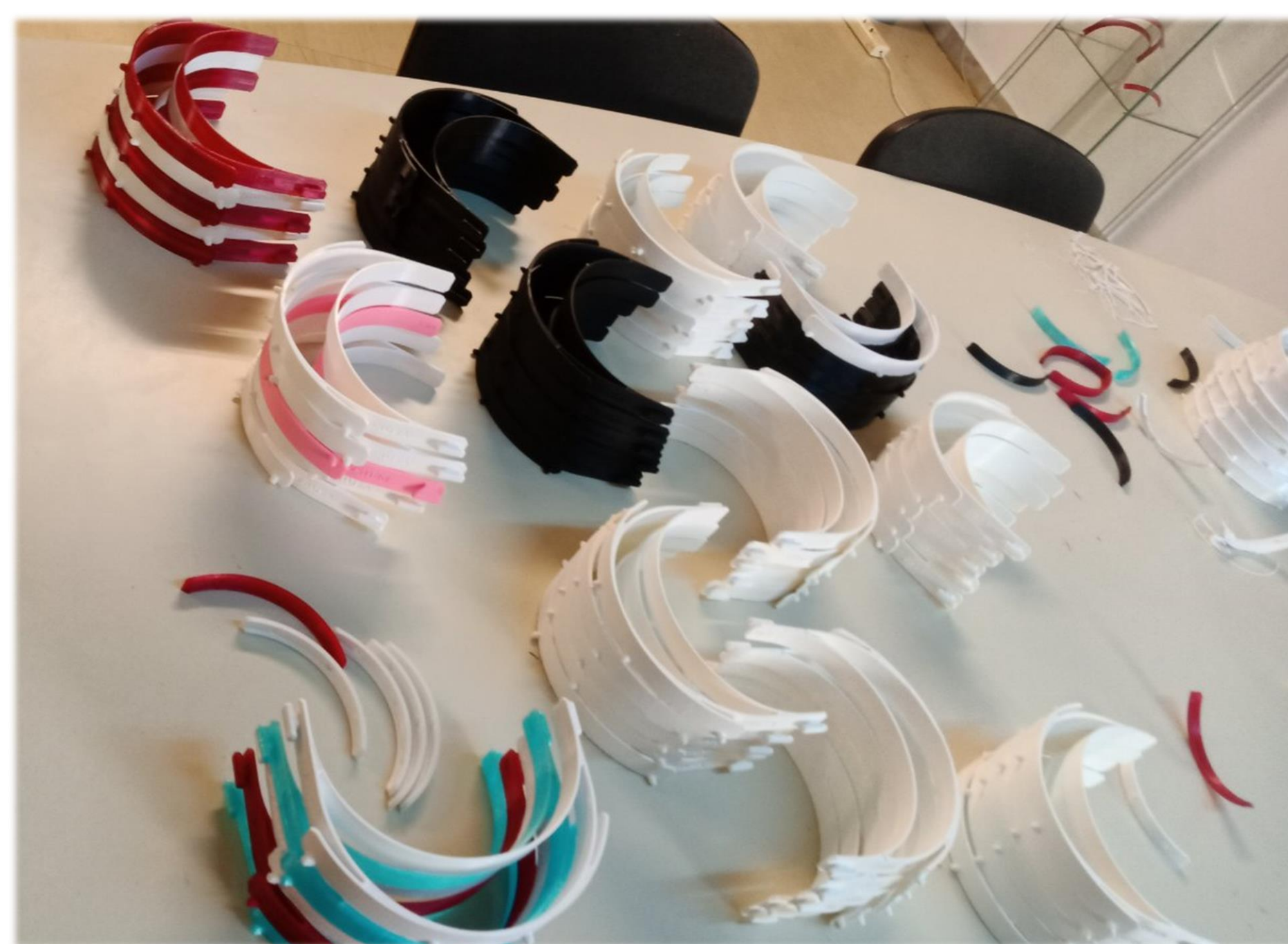
Εκτύπωση Face Shields στα πλαίσια συμμετοχής του Εργαστηρίου στο 3DP NTUA Hub στην προσπάθεια στήριξης και εξοπλισμού των νοσοκομείων του ΕΣΥ.
