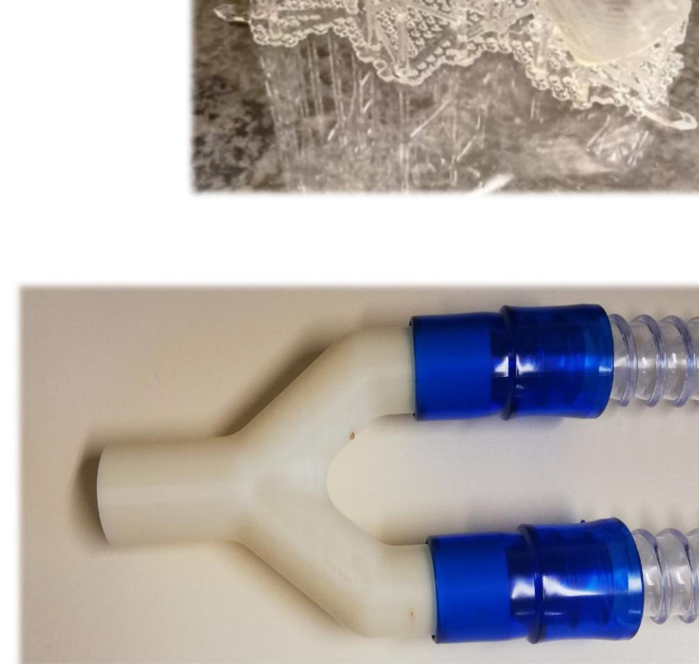
Χρήση τεχνολογιών FDM, SLA για την τρισδιάστατη εκτύπωση πρωτοτύπων splitters για ιατρικούς αναπνευστήρες
