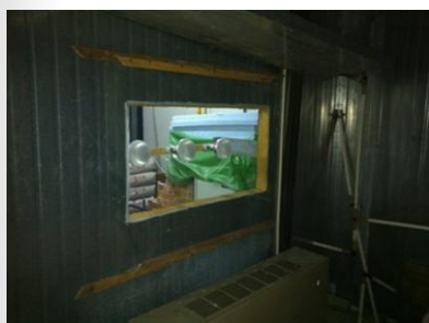
Προσομοιωτής υαλοστασίου και εισερχομένης ηλιακής ακτινοβολίας εντός του πειραματικού θαλάμου
