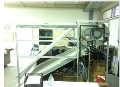
Μοντέλο συστήματος ηλιακής θέρμανσης νερού με προσομοιωτή
