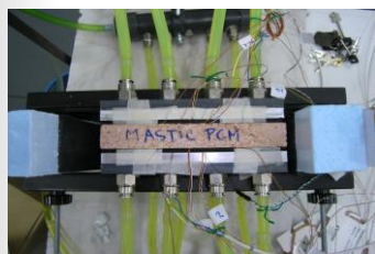
Πειραματική διάταξη μέτρησης ροής θερμότητας σε δομικά υλικά υπό μεταβατικές συνθήκες
