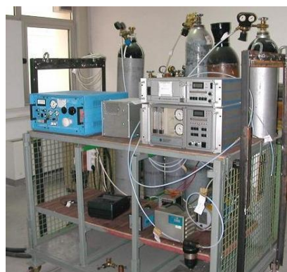
Διατάξεις αναλυτών καυσαερίων μόνιμης λειτουργίας (αριστερά) και δυναμόμετρο οχημάτων (δεξιά)
