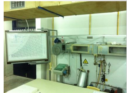
Εργαστηριακό μοντέλο κεντρικής κλιματιστικής συσκευής
