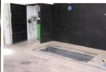
Διατάξεις αναλυτών καυσαερίων μόνιμης λειτουργίας (αριστερά) και δυναμόμετρο οχημάτων (δεξιά)
