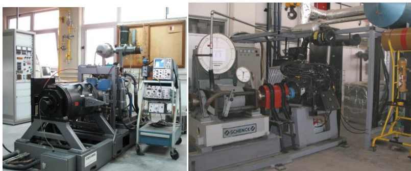
Πειραματικές διατάξεις πρότυπου μονοκύλινδρου (αριστερά) και πολυκύλινδρου υπερπληρωμένου κινητήρα Diesel (δεξιά) εργαστηρίου Μ.Ε.Κ.
